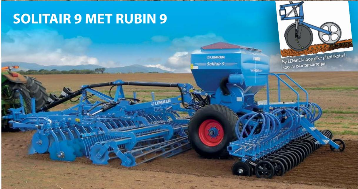
Die Solitair 9 van LEMKEN lewer nie net op sy eie puik resultate by die saai van fynsade nie, maar verminder bewerkings wanneer hy met verskeie LEMKEN implemente verbind word. Elektriese metereenhede en druklugverdeling verseker akkurate plasing teen hoë spoed. Deur in een gang die grond te bewerk en te plant beteken dat die boer die saad vinniger in die optimale plantvenster kan inkry.
